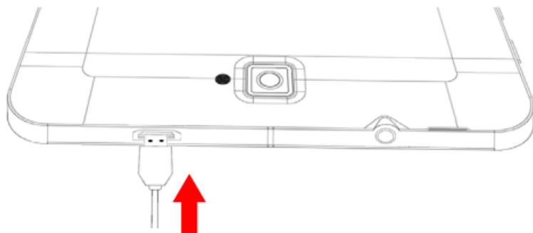
Заряжать батарею можно с помощью зарядного устройства, или подключив планшет к ПК через кабель USB.
